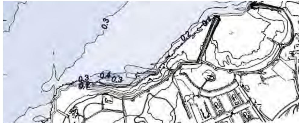
Figura 33.- Detalle gráfico de las propagaciones de oleaje (isolíneas de altura de ola) para los casos de altura de ola morfológica del NNE (Fuente: Elaboración propia)
