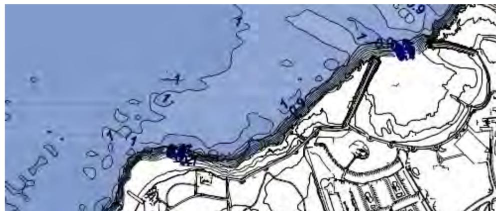
Figura 35.- Detalle gráfico de las propagaciones de oleaje (isolíneas de altura de ola) para los casos de altura de ola morfológica del E (Fuente: Elaboración propia)
