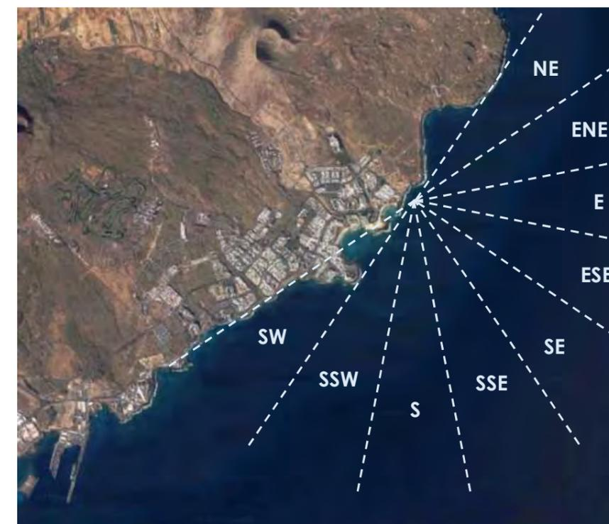
Figura 7.- Direcciones de incidencia del oleaje (Fuente: elaboración propia)
