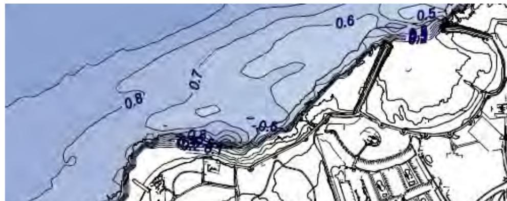
Figura 34.- Detalle gráfico de las propagaciones de oleaje (isolíneas de altura de ola) para los casos de altura de ola morfológica del NE (Fuente: Elaboración propia)
