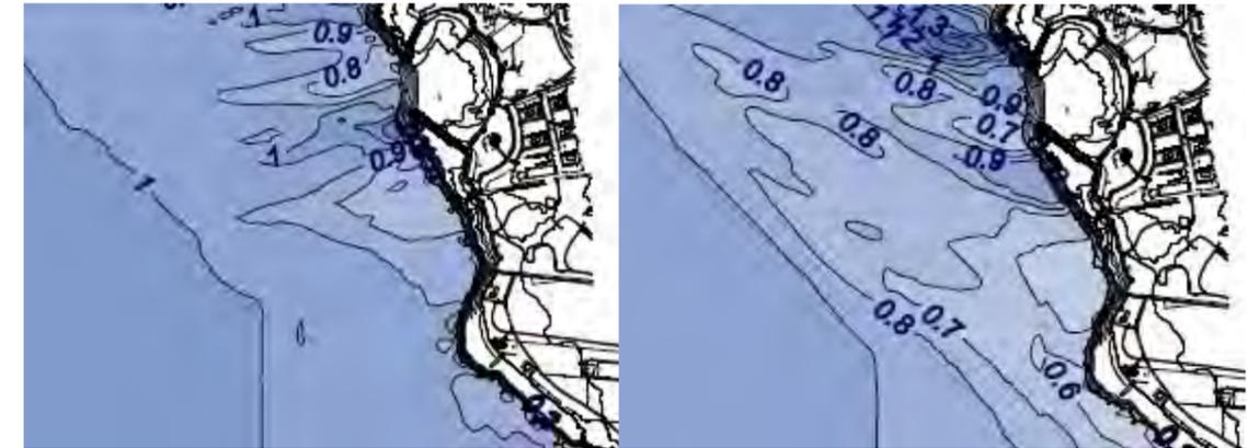
Figura 36.- Detalle gráfico de las propagaciones de oleaje (isolíneas de altura de ola) para los casos de altura de ola morfológica del Sur (iza) y SSW (dcha)(Fuente: Elaboración propia)
