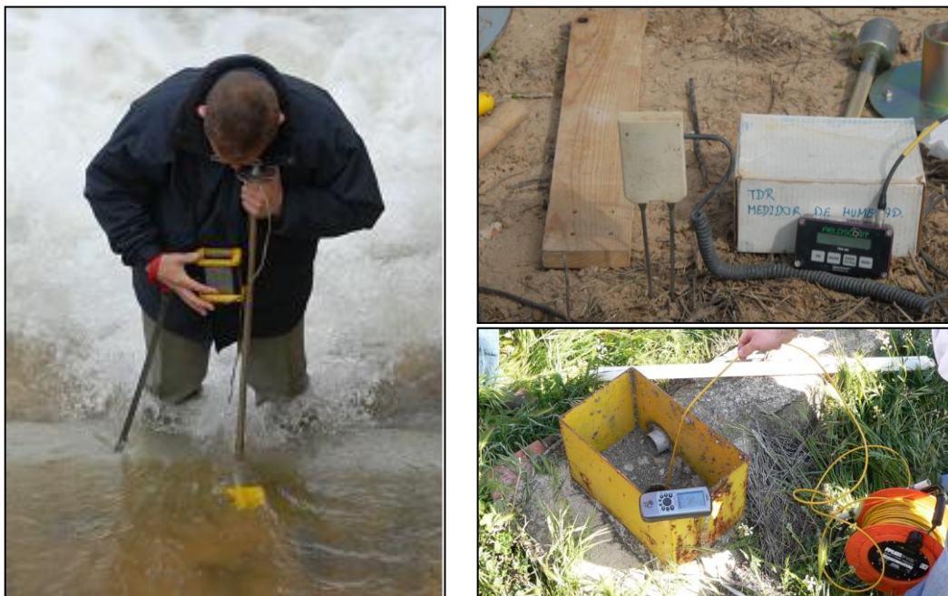
Ilustración 2: Realización de prácticas de aforo en río y registro de humedad en el suelo y del nivel piezométrico.
